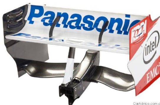
Rys. 2.15 Tylni spoiler auta F1 zakończony wingletami
