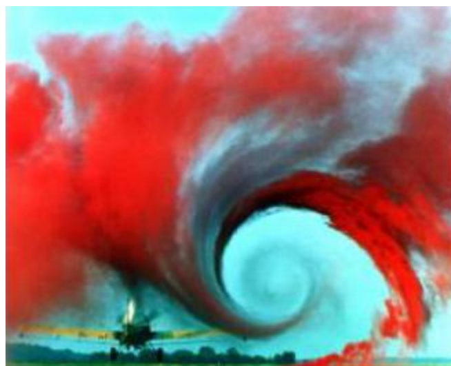
c) Zdjęcie wiru powstałego za samolotem pasażerskim przelatującym przez powietrze zabarwione świecą dymną
