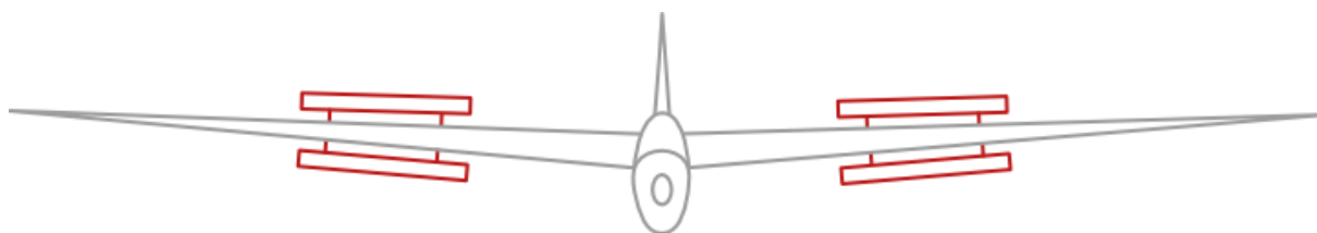
Rys. 2.45 Schematyczny rysunek szybowca z wysuniętymi hamulcami aerodynamicznymi
