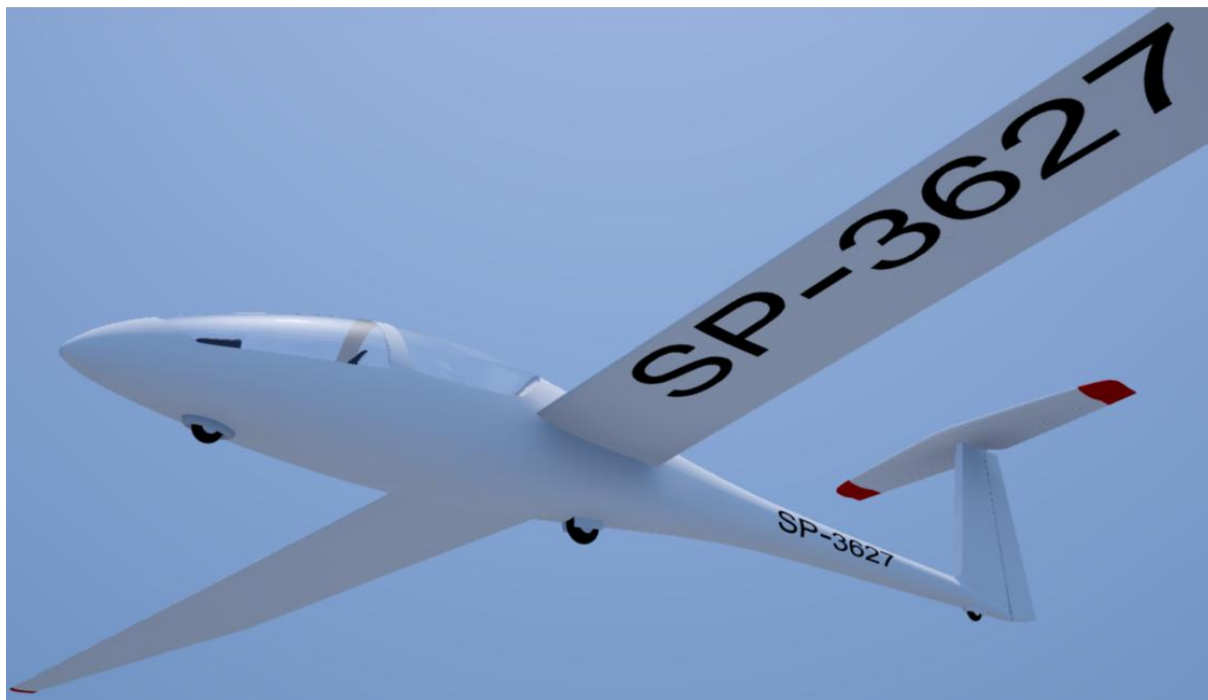
a) „rejestracja” umieszczona jest na ogonie oraz dolnej powierzchni skrzydła
